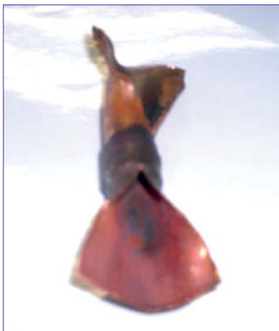
Пайка при недостаточном количестве азота (при наличии кислорода в контуре)
